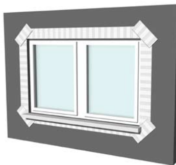
Obrázek č. 8: Výztužení okrajů stavebních otvorů sklotextilní tkaninou
