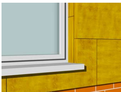
Obrázek č. 7: Provedení tepelného izolantu na ostění stavebních otvorů
